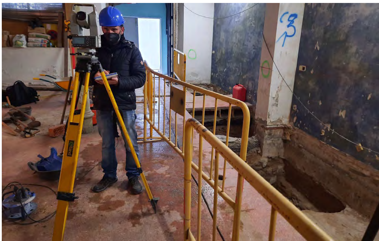
Fotografia del procés de documentació topogràfica de la intervenció realitzada a l'interior. 15/FEB/2021 (E. Píriz).
